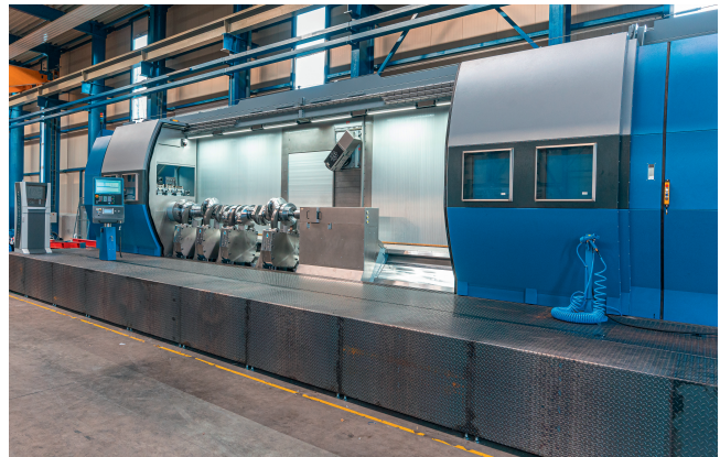
3 Weingärtner und Walter haben gemeinsam die Bearbeitung von Kurbelwellen optimiert; zentraler Bestandteil des Projekts für einen chinesischen Kunden war ein multifunktionales Drehfräszentrum mpmc 850 © Weingärtner
